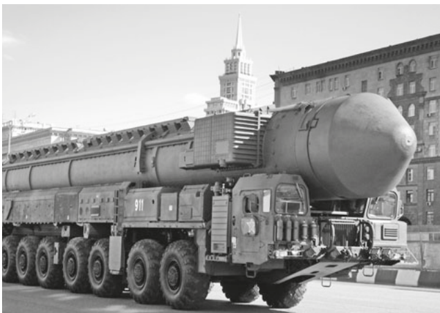
Eine ballistische Interkontinentalrakete des Typs Topol-M aus Russland – die Reichweite beträgt bis 11 000 km. (©Wikicommons)
