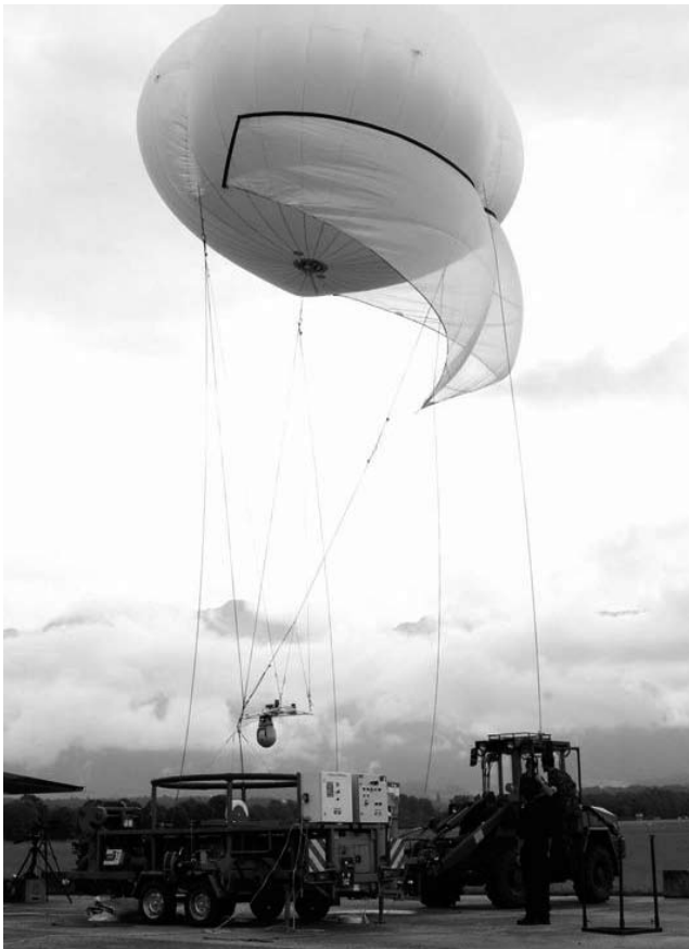
Mobiles Überwachungssystem: Radar- und optische Sensoren
