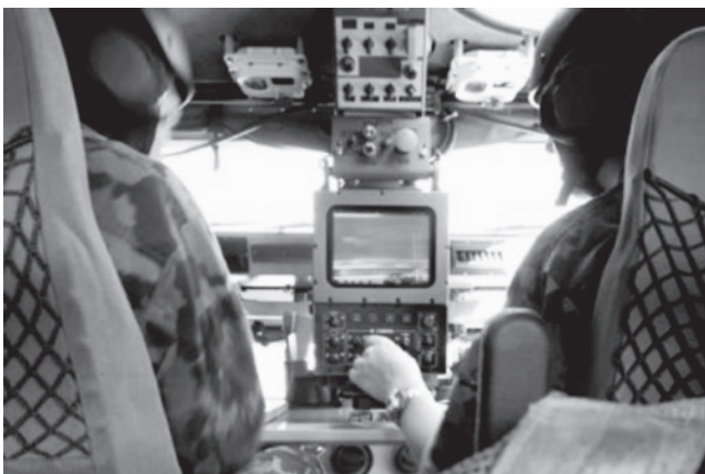
Vernetztes Feuerleitsystem der mechanisierten Artillerie: Eagle III 4x4 mit INTAFF (Schweizer Armee – ZEM)
