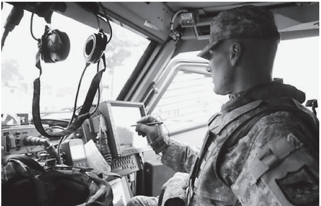
Force XXI Battle Command Brigade-and-Below/Blue Force Tracking system (FBCB2) im Einsatz bei der US Army in Afghanistan. (Quelle: US Army)
